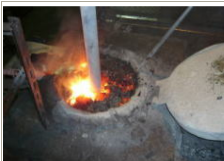
金属溶解工程
