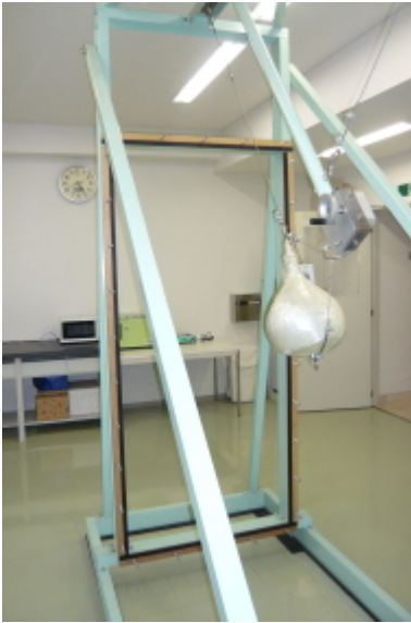
ショットバッグ試験装置 (45kgの鉛散弾入りバッグによる 板ガラス衝撃試験)
