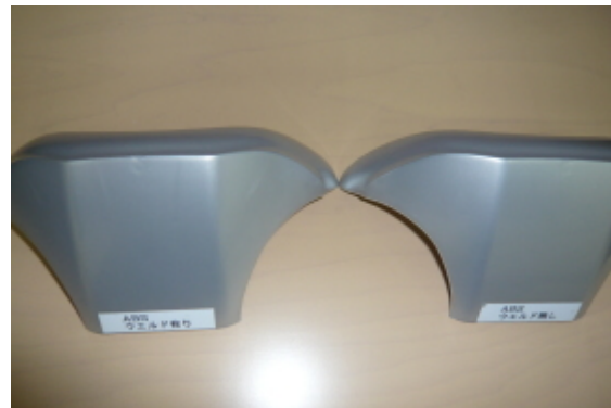
ABS樹脂 従来技術(左) ABS樹脂 ノンウェルド技術(右)
