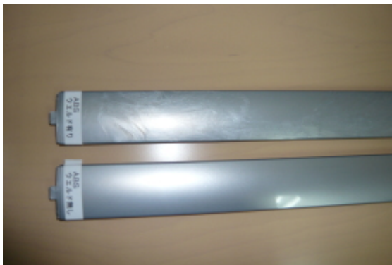
ABS樹脂 従来技術(上) ABS樹脂 ノンウェルド技術(下)
