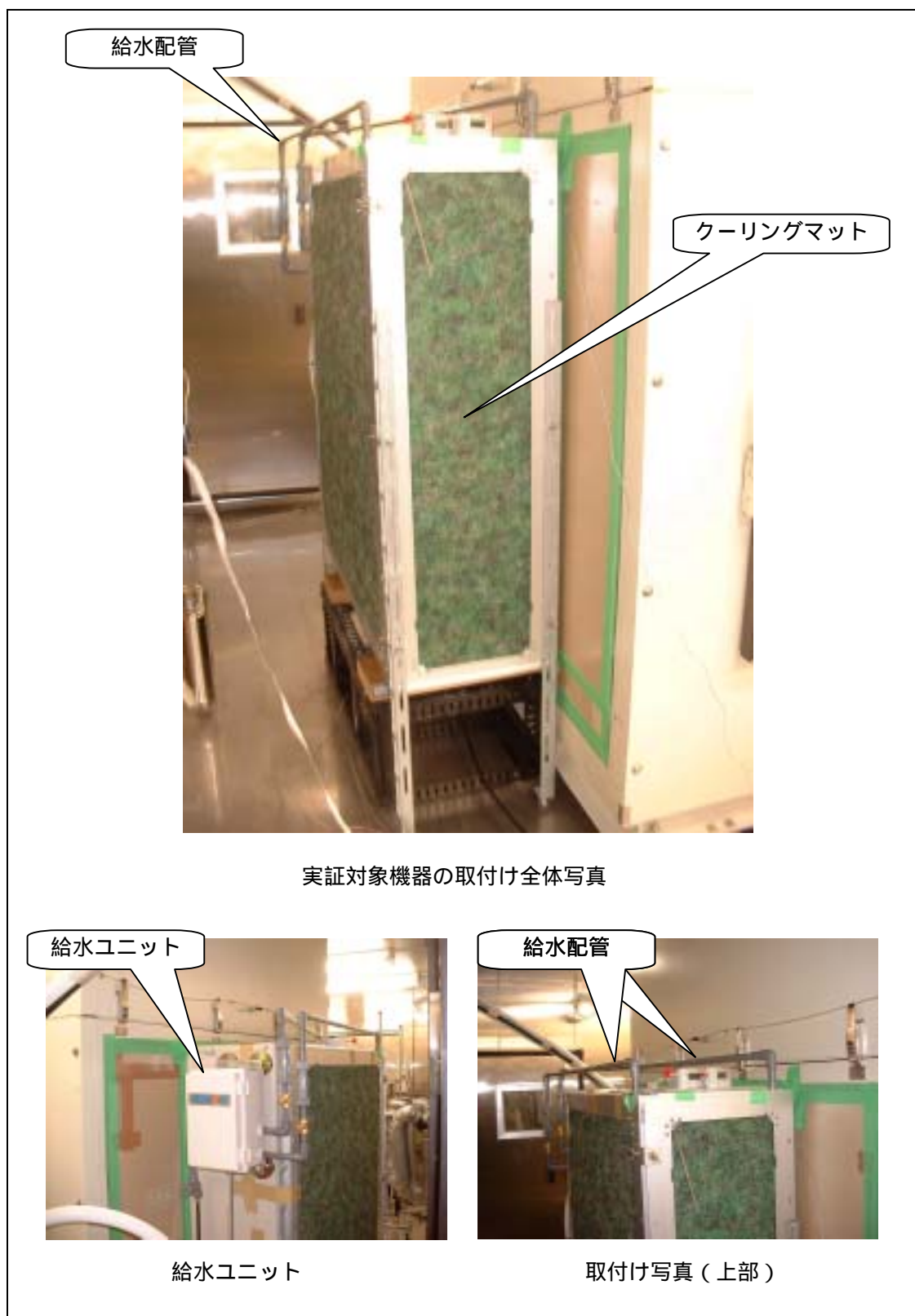
図 1 - 2 実証対象機器の設置状況
