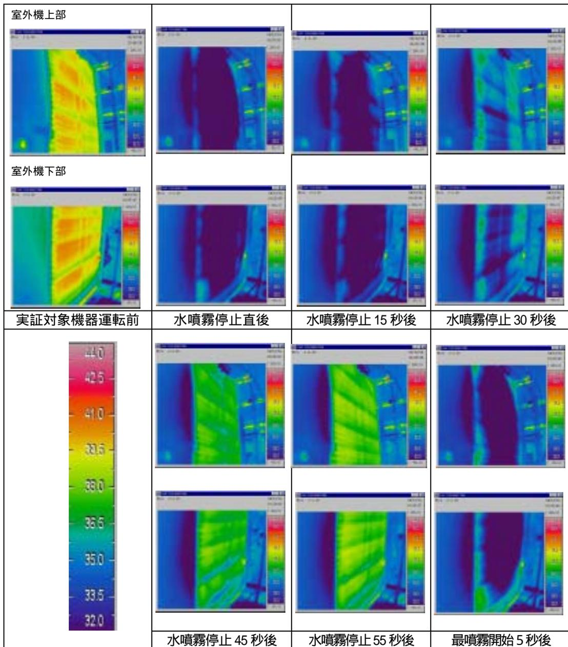
図 4 - 3 熱交換器フィン表面の温度変化
