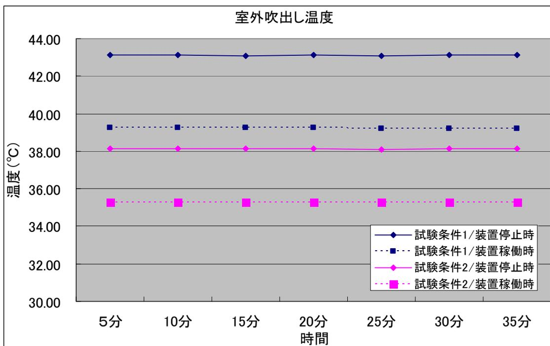
図 4 - 1 室外機吹出空気温度変化
