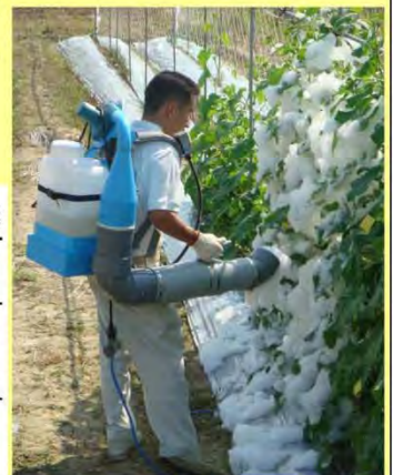
第3図 発泡散布装置によるキュウリへの散布の様子
