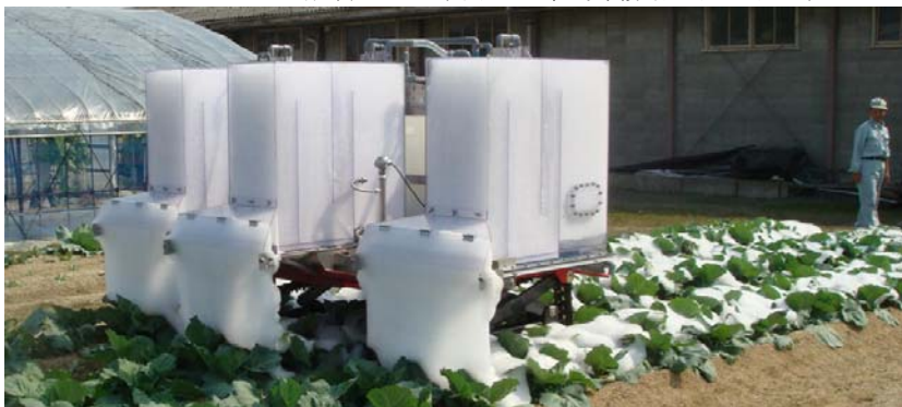
第1図 流下式発泡散布装置によるキャベツへの散布の様子
