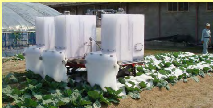
第1図 発泡散布装置によるキャベツへの散布の様子
