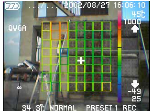
第2図 2次元放射温度計（サーモグラフィー）による表面温度分布測定 (2002年8月27日16:06測定)
