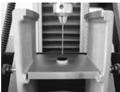
第1図 物性測定装置による水なす貫入試験
