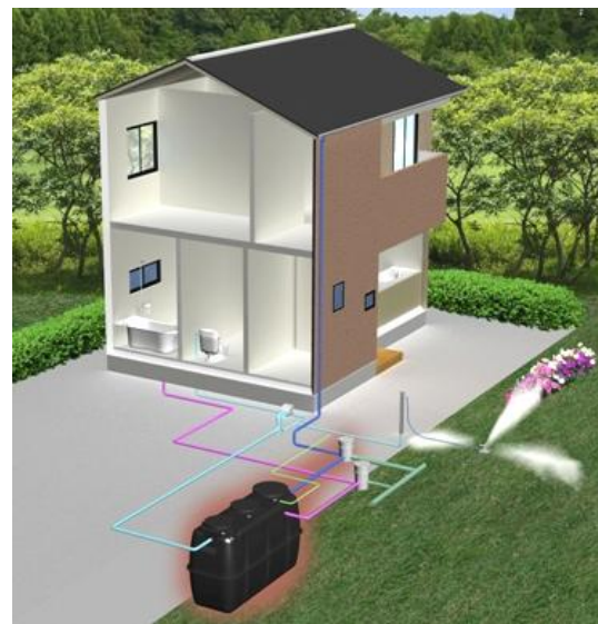
地下タンクに雨水を貯留して散水やトイレ洗浄に利用
