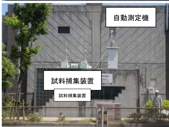
図2-1 試料捕集状況（自動測定機との位置関係）
