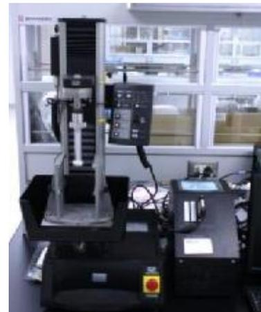
(2) 食感音響測定装置 (嚙音 (Come-in)、有限会社生物振動研究所)
