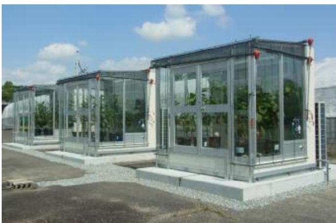
図4 人工気象栽培装置
