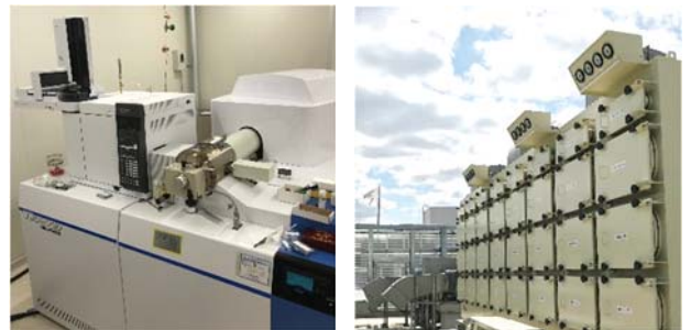
図1 高分解能GC/MSと排気設備
