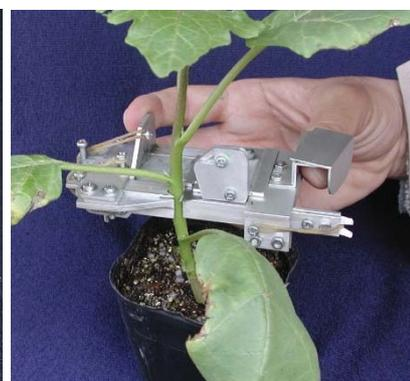
写真3 試作した台木用切断器具
