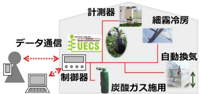
遠隔での水ナスの栽培環境監視・制御
