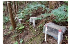
図2 土砂受け箱の設置状況
