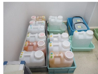
廃液の分別保管
