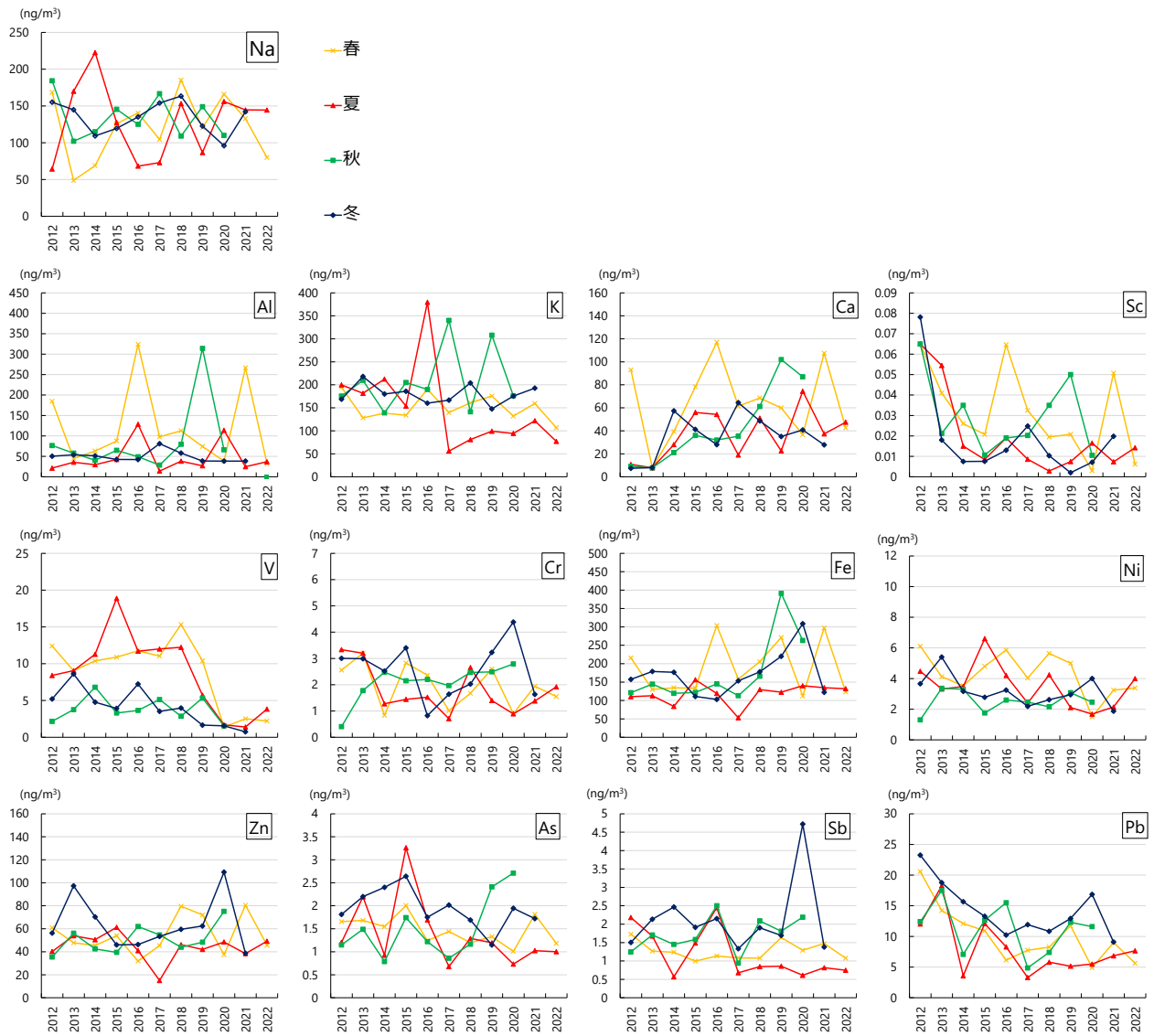
図 34 PM 2.5 質量濃度が 15 \mu\text{g}/\text{m}^3 を上回った日の無機元素濃度の経年変化 (泉大津)
