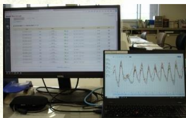
(左)ブドウハウスに設置した温度計測装置、(右)パソコン画面に表示した各計測機一覧と各所の温度推移
