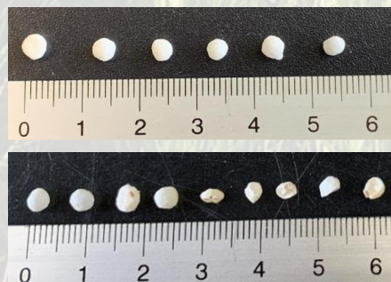
上は施用前のプラスチック被覆肥料、下は排水路から回収された肥料殻。プラスチック被膜がそのままの形で一部水系に流出していることが確認されています。
