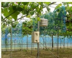
(左)ブドウハウスに設置した温度計測装置、(右)パソコン画面に表示した各計測機一覧と各所の温度推移
