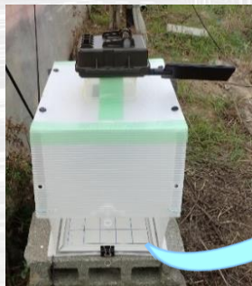
IoT カメラ付き粘着式フェロモントラップの外観と送信された画像 (画像は金子ら(2021)より関西病虫害研究会の承諾を得て転載)
