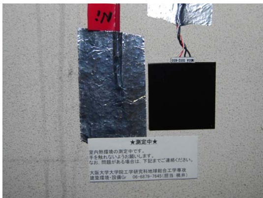
図 2.27 北側壁面温度及び熱流計
