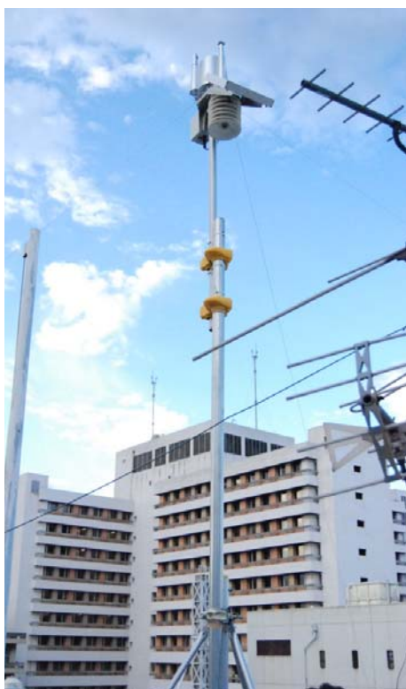
図 2.13 ウェザーバケット設置状況
