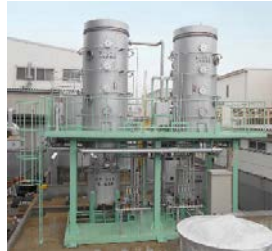
湿式NOx除去・硝酸回収技術 「MKNシリーズ」 （株）公害防止機器研究所
