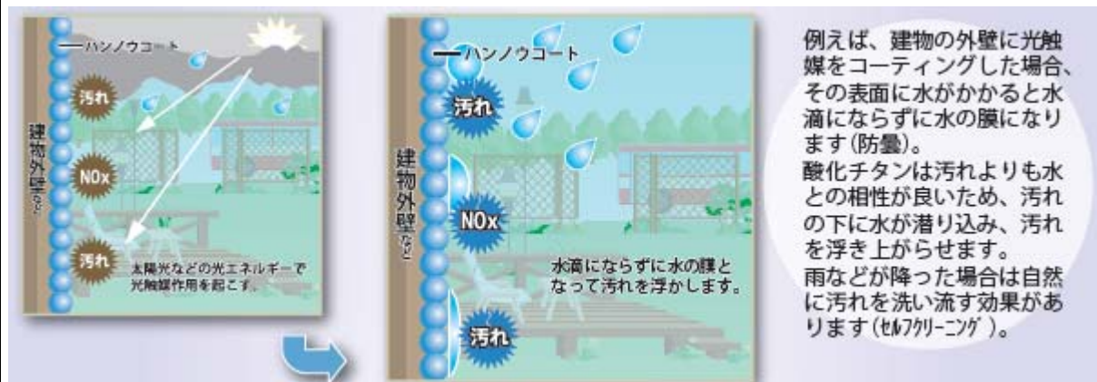
※セルフクリーニングのメカニズム(イメージ図)
