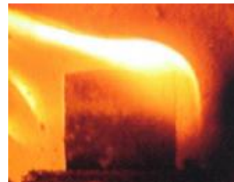
炉の中で高温で燃焼する バイオコークス
