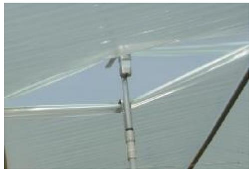
写真2 開発した装置で天井ビニールを開けているところ
