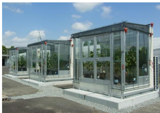
新設した周囲温湿度追従型人工気象栽培装置
