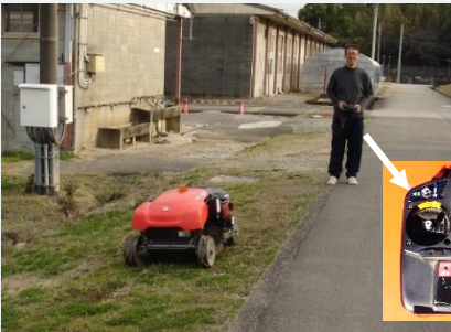
ラジコン草刈機を操作している様子 右のコントローラーを使って本体から5~10mほど離れて操作します。斜面の草刈りも可能です。
